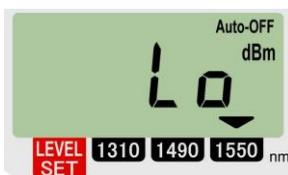
自動補正を中止させたい時は、自動補正中を示す数字が表示されている間に再度“λボタン”を押すと、dBm 表示になります。オフセット補正はされていませんが、測定は可能です。
